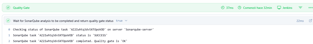
Figura 84. Resultado satisfactorio de la etapa Quality Gate en Jenkins tras el análisis de SonarQube.
