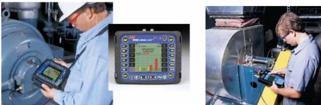
Figura 4. Medición de vibraciones.
