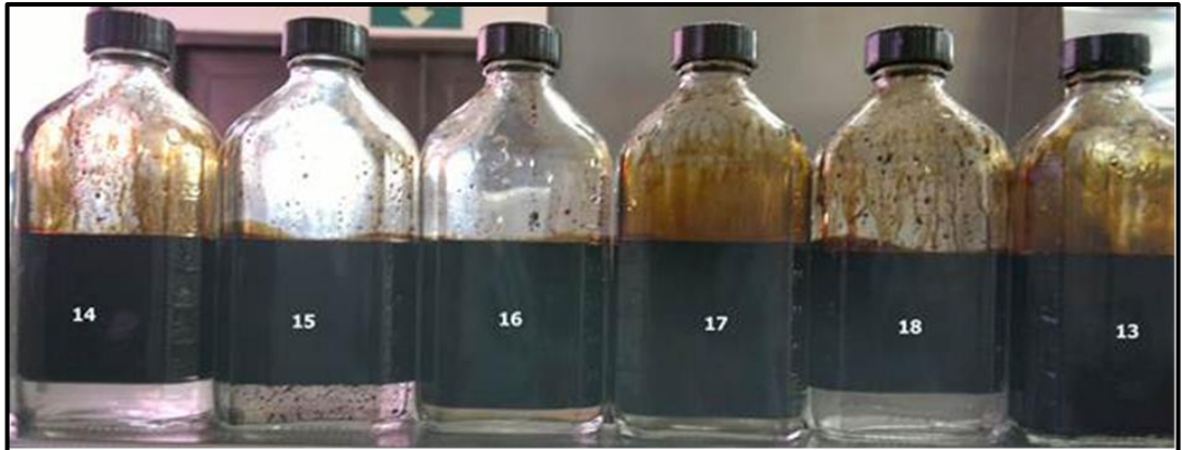
Figura 36. Prueba de la botella. Crudo sin espuma.
