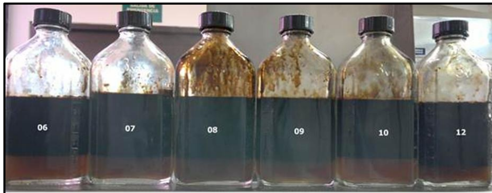
Figura 38. Prueba de la botella. Con espuma HY4.
