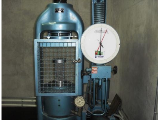
Ensayo a Compresión
