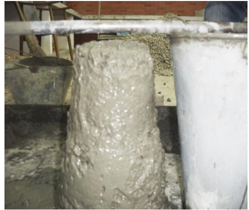
Prueba de asentamiento
