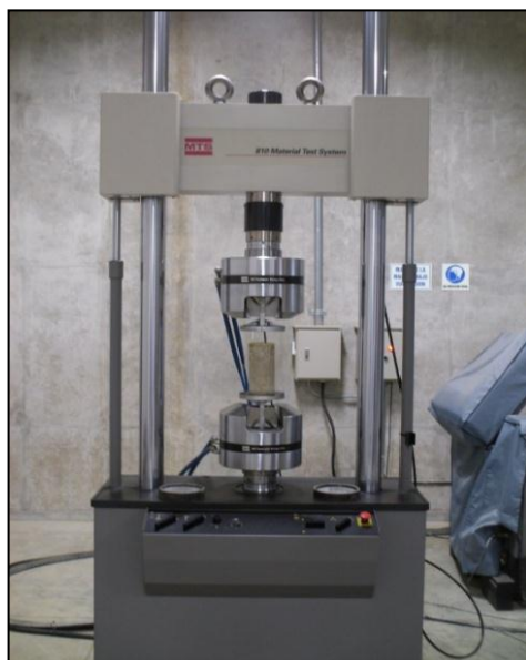
Figura 1. Ensayo de probetas a compresión.
