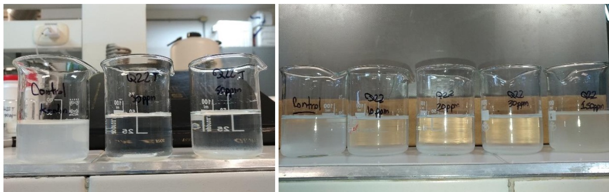
Figura G3. Floculación de Caolinita con PGQ-3 (Q22)
