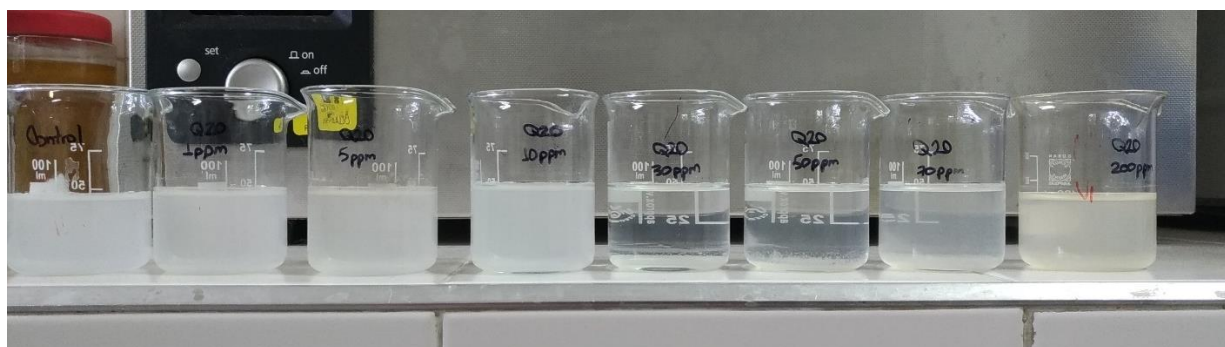
Figura G2. Floculación de Caolinita con PGQ-1 (Q20)
