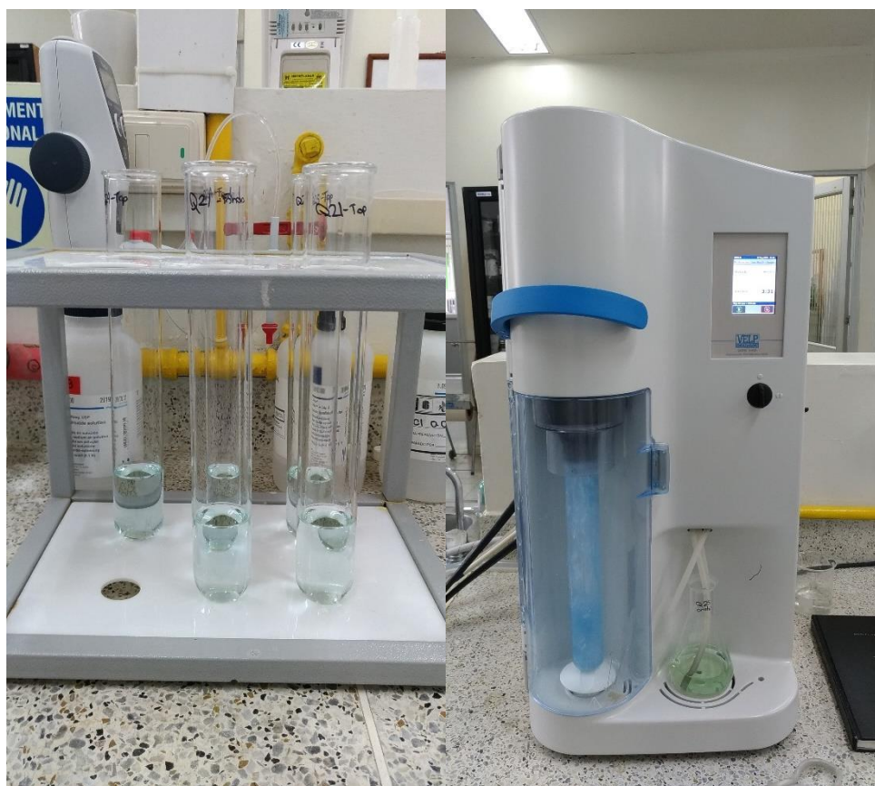
Figura G2. Preparación de muestras y destilación de la solución de digestión con vapor de agua en presencia de NaOH.
