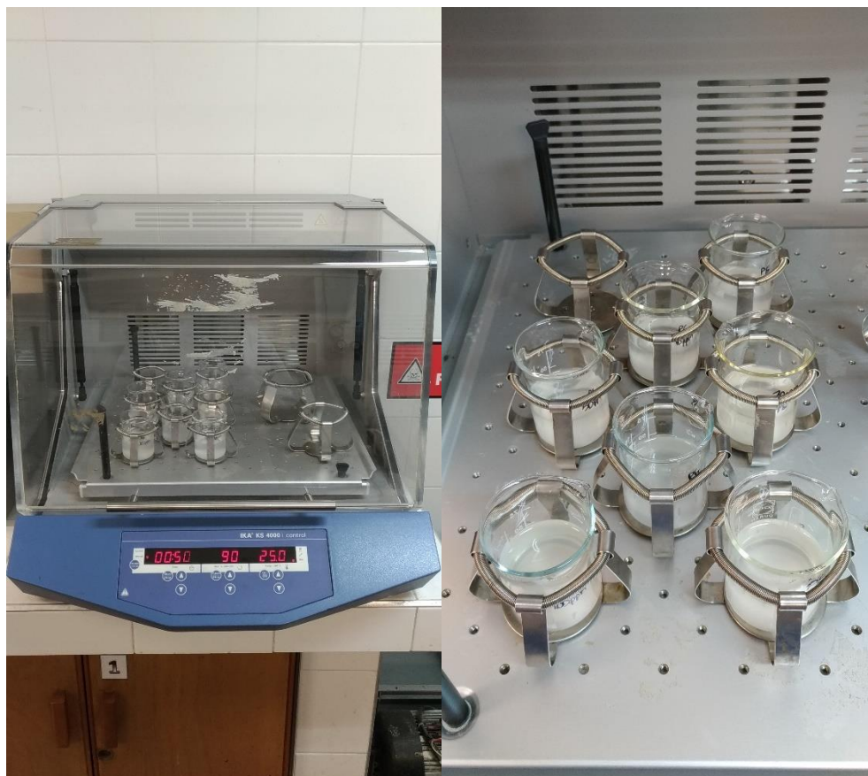
Figura G1. Configuración floculación en Shaker KS4000
