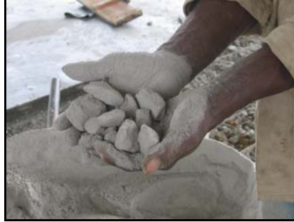
Figura 19. Terrones de material presentes en los sacos de cemento
