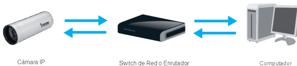
Figura 5. La forma en que se conecta la cámara IP al computador, mediante un puerto de red.
