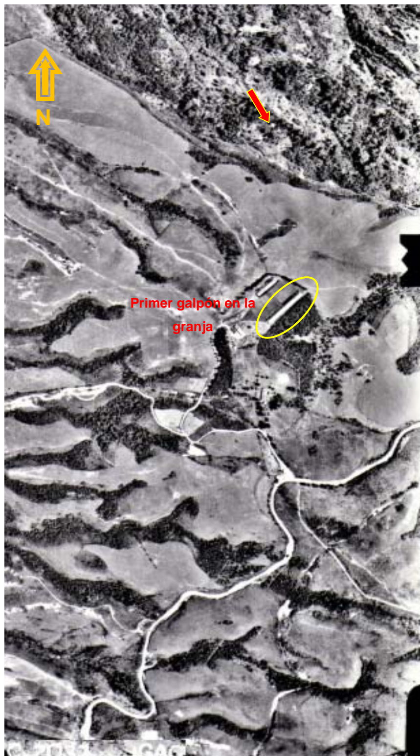
Foto 40. Fotografía aérea del sitio del deslizamiento antes de la construcción de las lagunas artificiales pertenecientes a la Granja San Sebastián. La flecha indica la zona donde actualmente se encuentra el deslizamiento.
