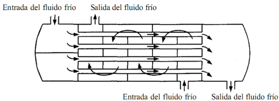
Figura 14. Intercambiadores de calor de tubos y coraza: a) un paso por la coraza y un paso por los tubos, b) un paso por la coraza y dos pasos por los tubos.
