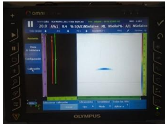
Figura 55. Interfaz para el inicio de la calibración de sensibilidad.
