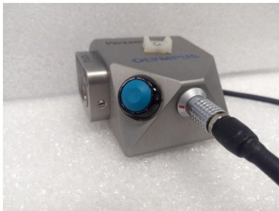
Figura 92. Conexión cable codificador – Escáner VersaMOUSE
