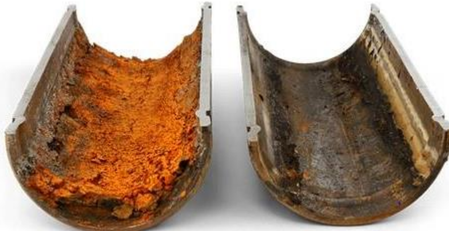
Figura 5. Corrosión de Oleoductos
