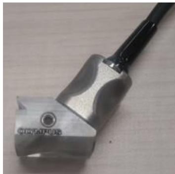
Figura 20. Sonda y cuña angular ensambladas
