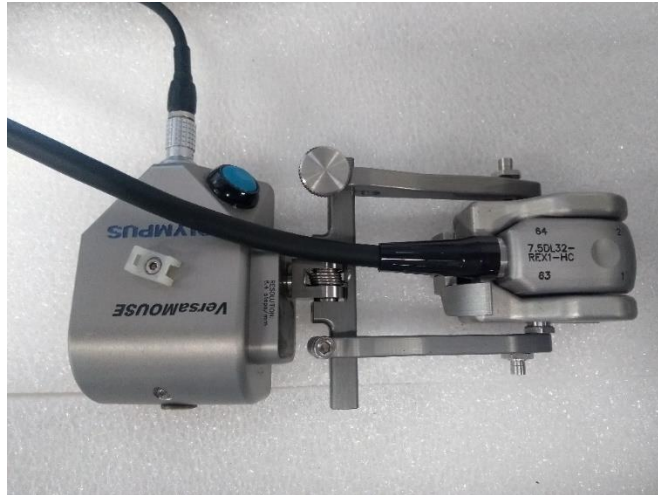
Figura 93. Montaje VersaMOUSE-yugo PA ajustable-sonda
