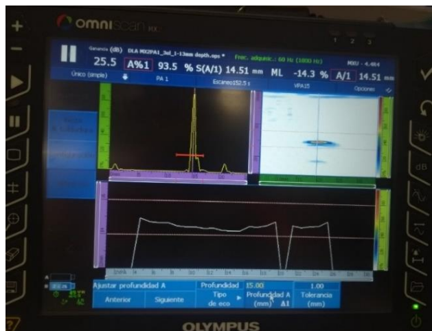
Figura 80. Menú para ajuste de profundidad A.
