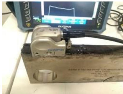
Figura 64. Sonda sobre el bloque de calibración
