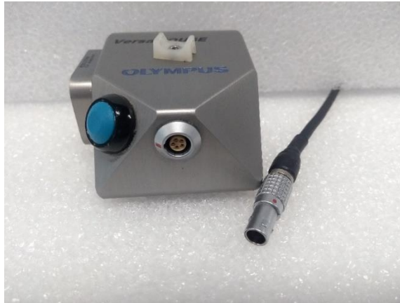
Figura 91. Punto de conexión escáner VersaMOUSE
