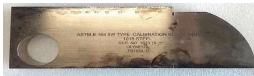
Figura 12. Bloque de referencia ASTM IWW de Olympus
