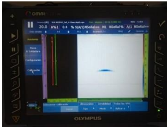
Figura 66. Interfaz para el inicio de la calibración de velocidad
