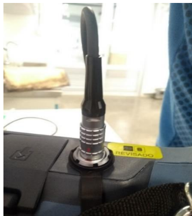
Figura 90. Conexión cable codificador – Omniscan MX2
