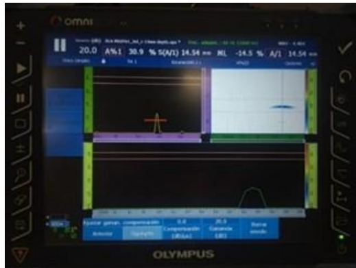
Figura 63. Ajuste de ganancia y compensación
