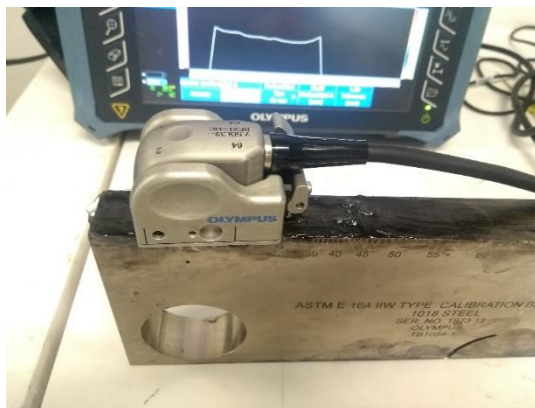
Figura 83. Posicionamiento de la sonda retardo de suela.
