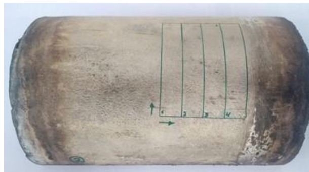
Figura 31. Tubería N°2 para análisis de porosidades
