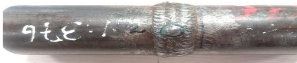
Figura 115. Tubería de inspección de soldadura punto 2.
