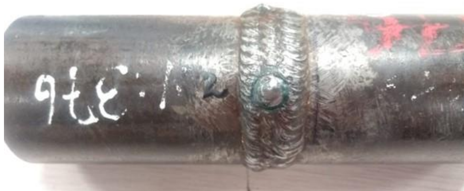
Figura 34. Tubo para inspección de soldadura
