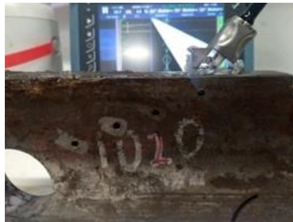
Figura 25. Bloque de calibración y palpador angular
