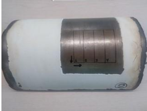
Figura 47. Pieza para inspección de porosidades
