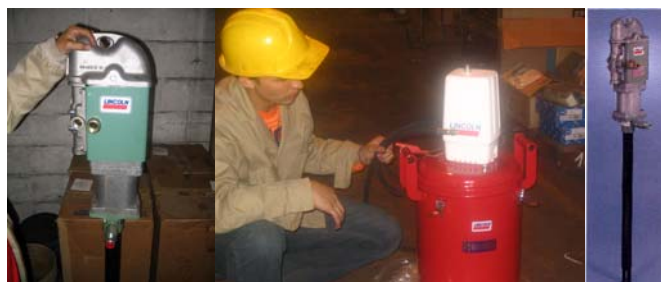
Figura 36. Bombas LINCOLN accionadas por aire (neumáticas) para sacar aceite de un tambor en posición vertical y portátil para facilitar el trabajo de los lubricadores
