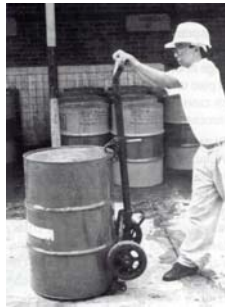
Figura 18. carretillas de mano. son muy eficaces para el movimiento de los tambores. Con una de estas carretillas un hombre solo puede manejar fácilmente los envases más pesados.
