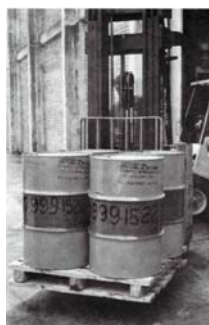
Figura.19 Monta-cargas. Permite manipular hasta 4 tambores de 55 galones colocados sobre una estiba de madera. Este sistema resulta muy práctico cuando se trata de grandes cantidades de aceite y es muy eficiente por su rigidez y porque no deteriora el tambor. Adicionalmente, la estiba permite el almacenamiento sobre estructuras metálicas o a la intemperie. Cuando se manipule con el montacargas un solo tambor, se debe tener la precaución de tomarlo por la parte central, entre los anillos que tiene exteriormente para evitar que se resbale.
