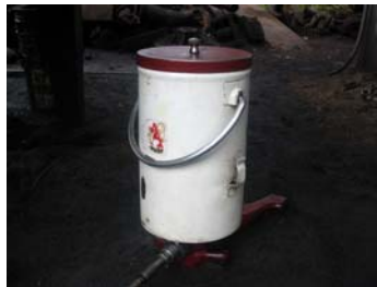
Figura 35. Bombas de pedal, marca ALEMITE para una capacidad de 28 libras
