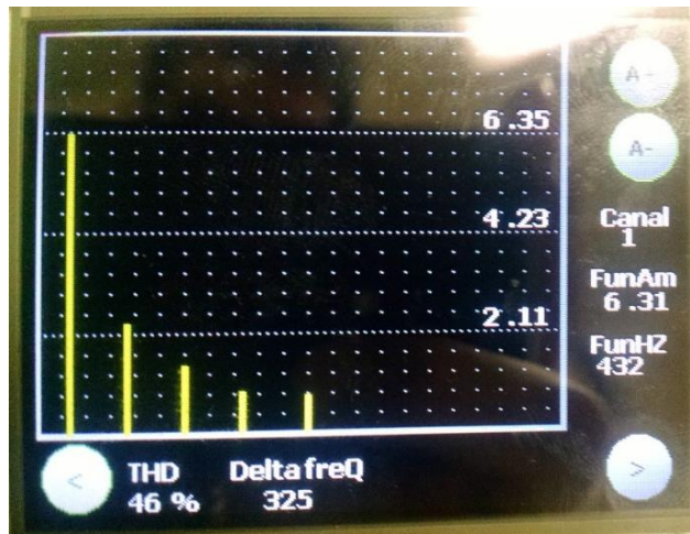
Figura 37. Espectro de frecuencia una señal cuadrada de 395 [Hz] visualizada en el sistema.
