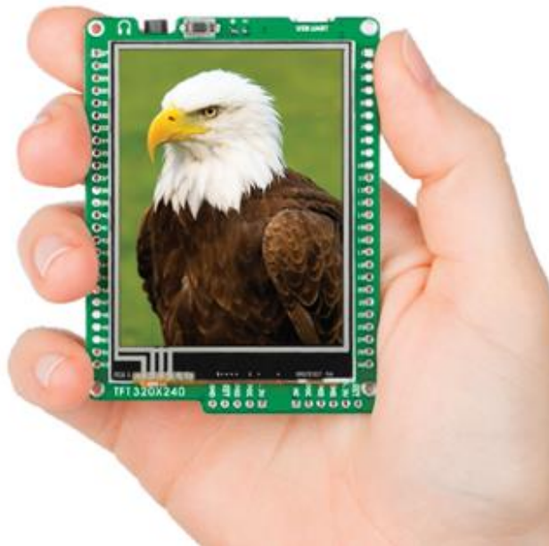
Figura 2. Sistema de desarrollo Mikromedia para dsPIC33®
