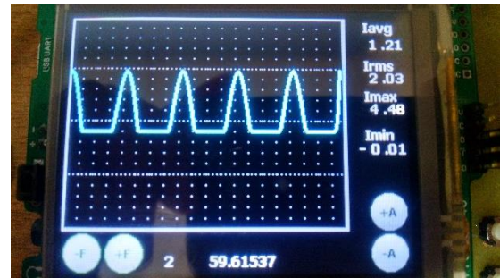
b. Señal de corriente en el sistema
