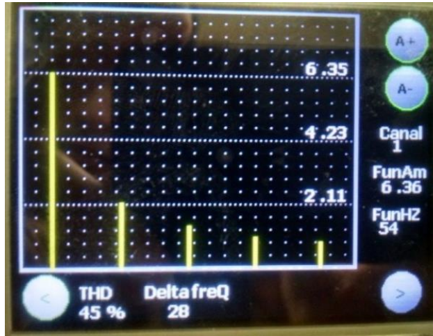
Figura 36. Espectro de una señal cuadrada de 60 [Hz] visualizada en el sistema.
