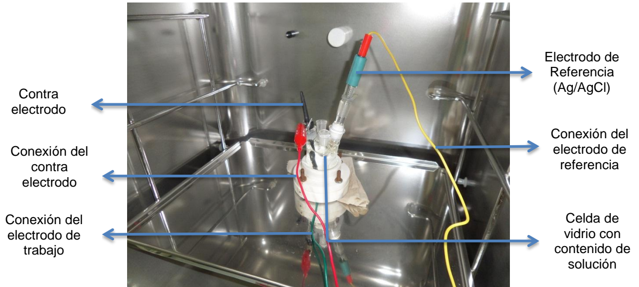
Figura 6: Celda utilizada para la realización de pruebas electroquímicas.
