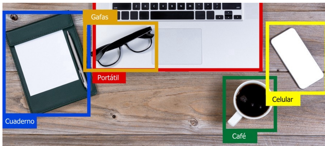
Figura 7. Imagen resultante de una red neuronal de detección, capaz de identificar 5 objetos diferentes, cuyas coordenadas de detección están representadas por los rectángulos que encierran a cada una de estas con su respectiva etiqueta. Tomado y traducido de 42 .
