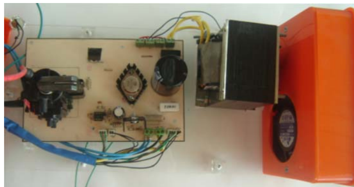
Figura 10. Circuito interno de la fuente.
