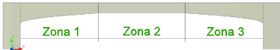
Figura 2. Sección transversal placa maciza de sección variable.
