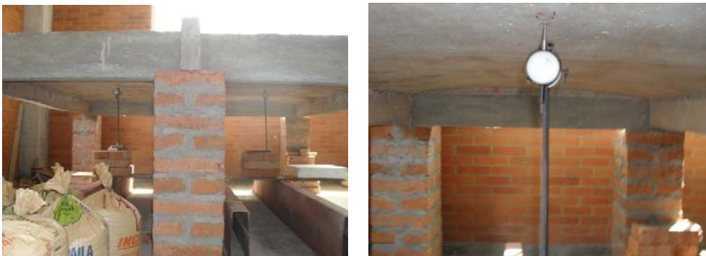
Figura 55. Ubicación de Deformímetros.
