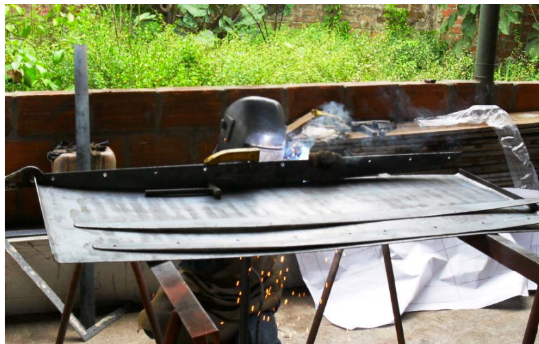
Figura 17. Soldadura de la lámina superior con láminas exteriores.
