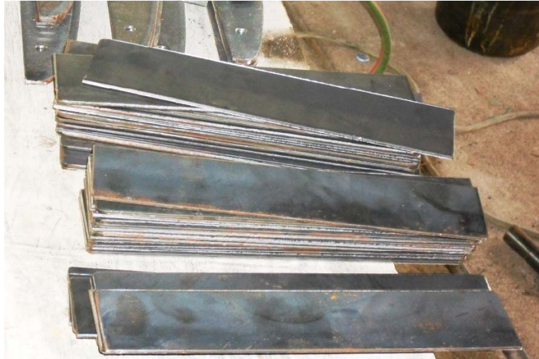
Figura 18. Corte de rigidizadores transversales del encofrado.
