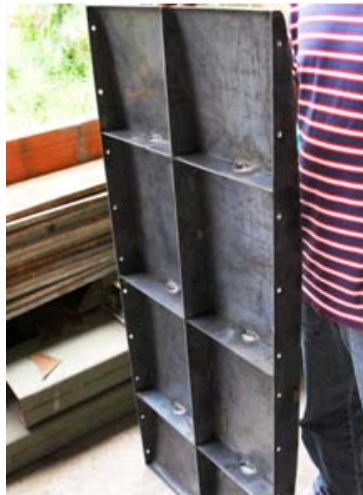
Figura 9. Fotografía formaleta en Construcción.
