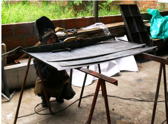
Figura 16. Adecuación de la lámina superior con láminas exteriores.
