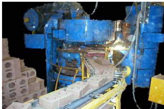
Figura 9. Prensado para la obtención de unidades de mampostería.
