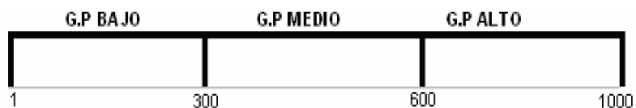
Figura 8. Escala de Grado de Peligrosidad
