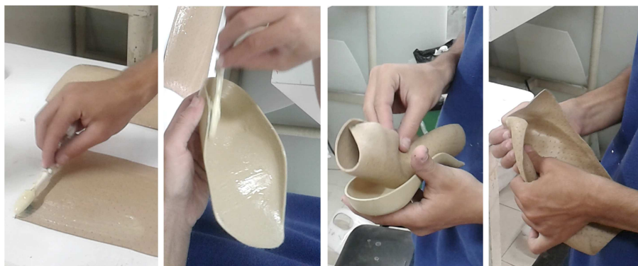
Figura 26. Adhesión del forro.
