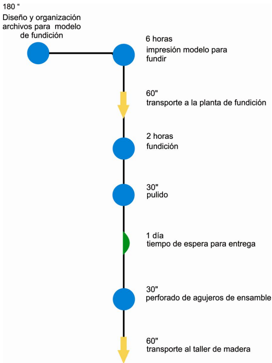
Ilustración 36. Diagrama de flujo producción herrajes
