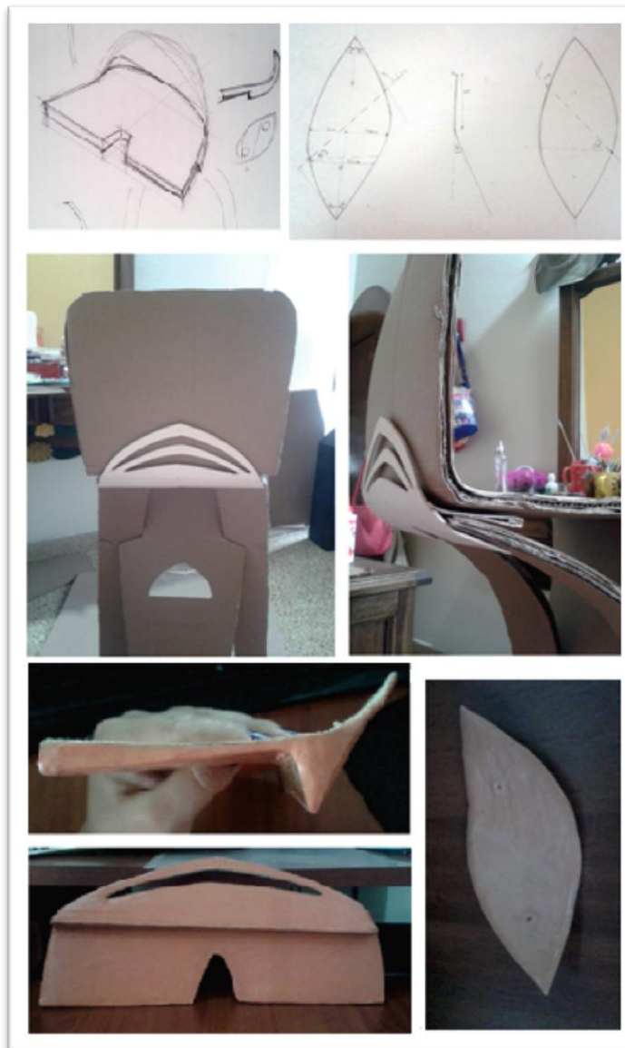
Ilustración 28. Proceso de diseño y modelos para los herrajes
