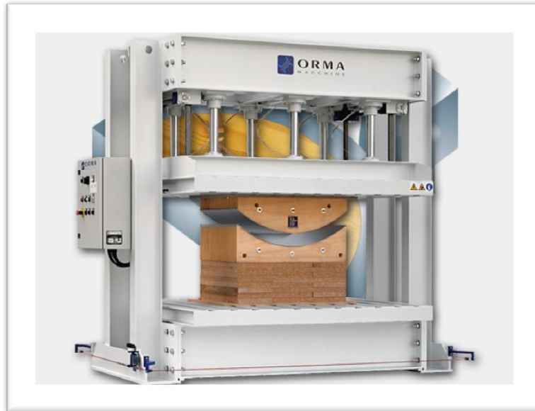
Figura 8. Prensa hidráulica con moldes para formas curvas.
