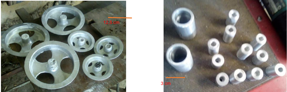
Imagen 10: Rines y bujes fundidos en moldeo por arena
