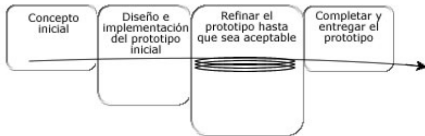
Figura 12. Modelo de prototipado evolutivo.
