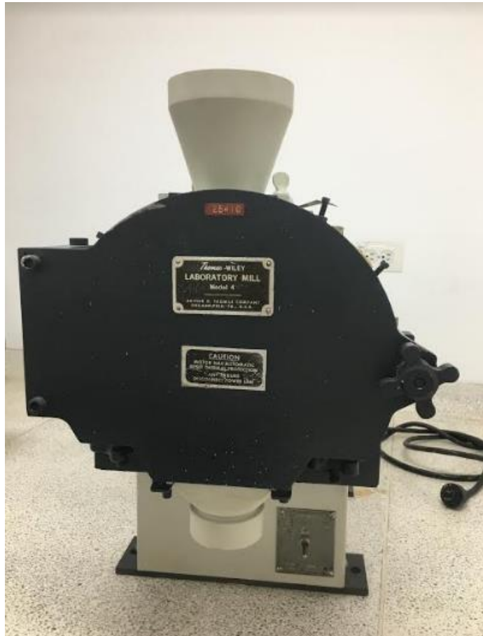
Figura 6. Molino de cuchillas THOMAS-WILEY
