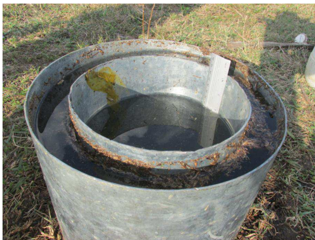
Fotografía 2: Prueba de infiltración realizada mediante el método de doble anillo.
