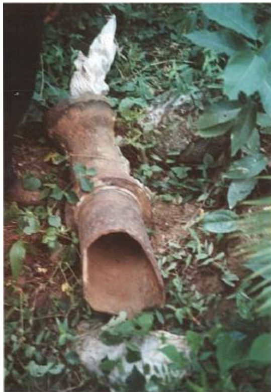
Fotografía 19. Tipo de fractura en la fundición gris
