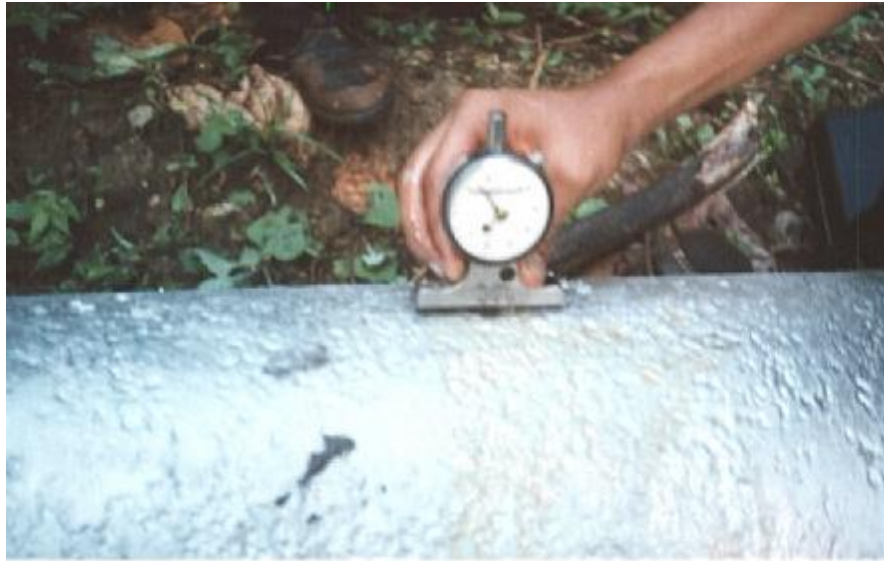
Fotografía 24. Pit Gage para Medición del picado
