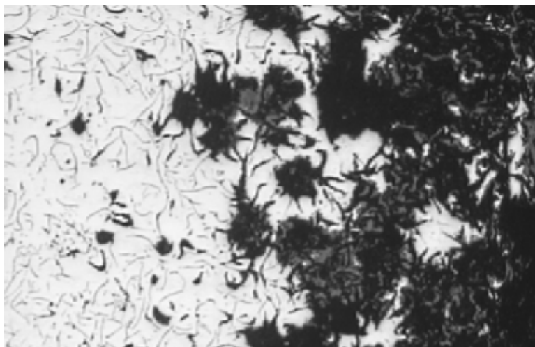
Fotografía 25. Corrosión Gráfica 50X aumentos
