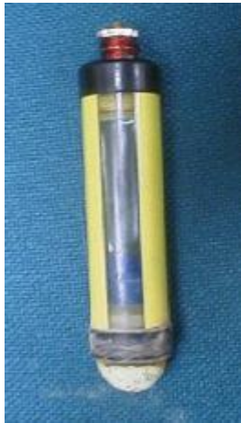
Fotografía 21 y 22. Electrodo de referencia Cu/CuSO 4 y multímetro de alta impedancia
