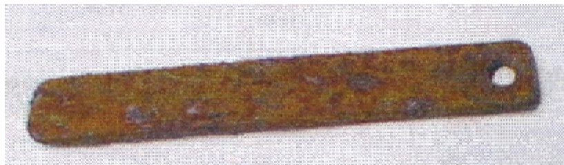
Fotografía 26. Cupón de fundición gris
