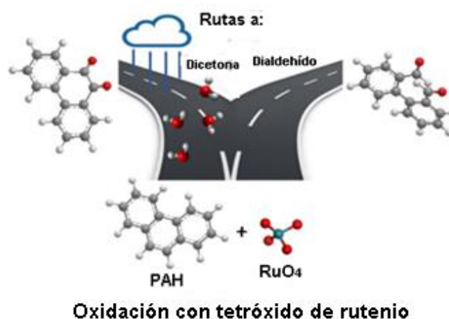
Figura 2. Mecanismo de reacción con iones de rutenio.
