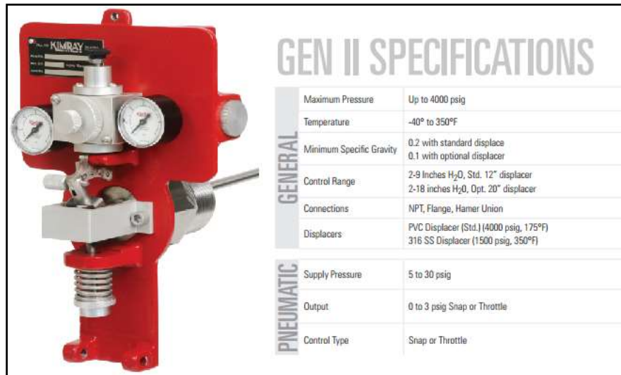
Figura 24: Especificaciones del sistema de control de nivel
