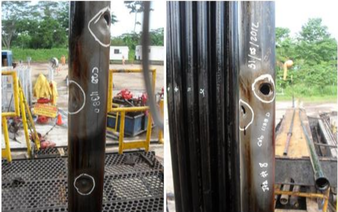
Figura 39. Ejemplo de tubería con fenómeno de “Jeteo”
