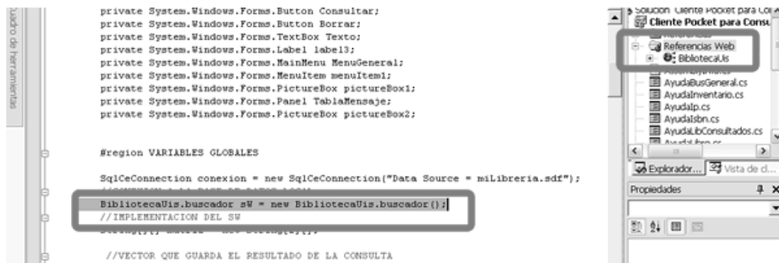
FIGURA No 32 , Pantalla que muestra como crear un objeto a partir de la clase creada de la referencia al servicio Web XML
