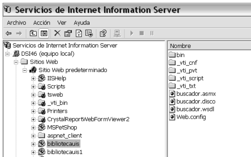
FIGURA No 24 , Disposición de las páginas que corresponde a la aplicación que reside en el servidor de desarrollo, en ella se ven los diferentes componentes de la aplicación servidor, el servicio Web XML tiene como nombre buscador.asmx , el archivo descriptor buscador.wSDL y el archivo de descubrimiento tiene el nombre de buscador.disco
