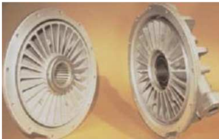
Figura 57. Impulsor y Turbina.
