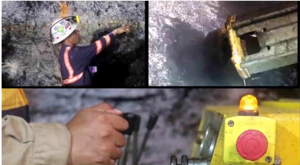
Figura 20. Proceso de Perforación sobre el manto.
