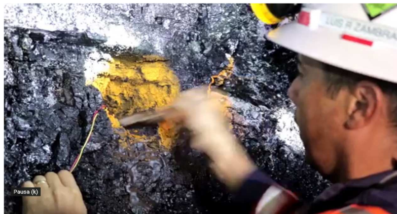
Figura 21. Instalar Explosivos con Tapones de Arcilla.
