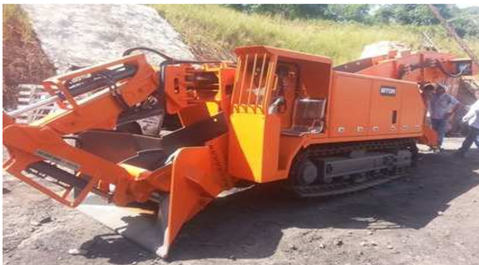
Figura 7. Retroexcavadora y/o Mucking Siton ZWY-80/45L.
