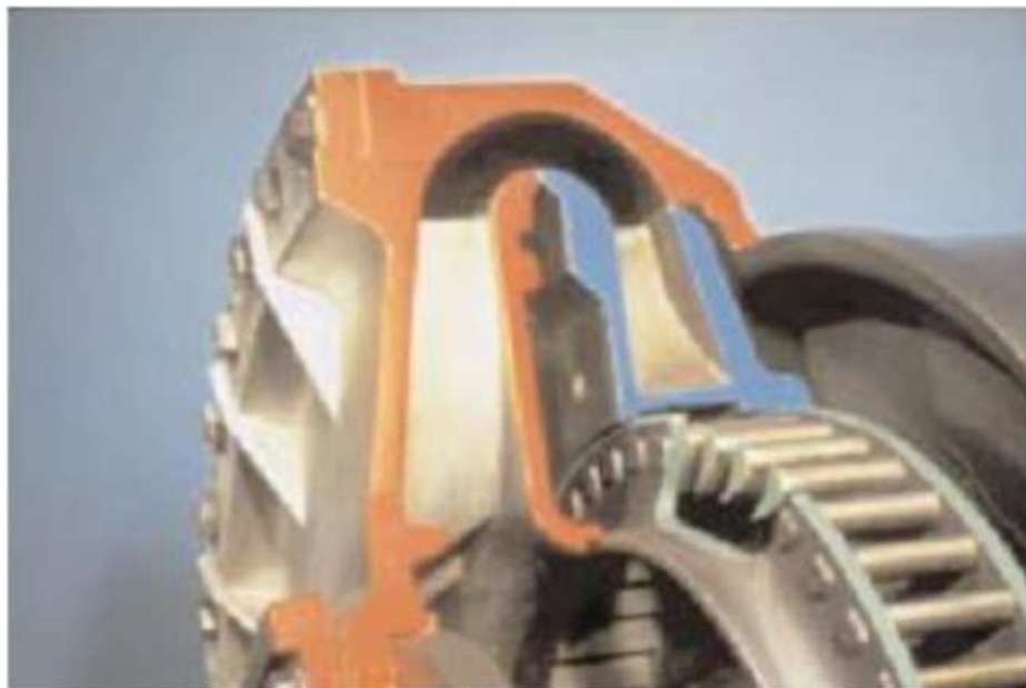
Figura 60. Rodete, Turbina y Estator.
