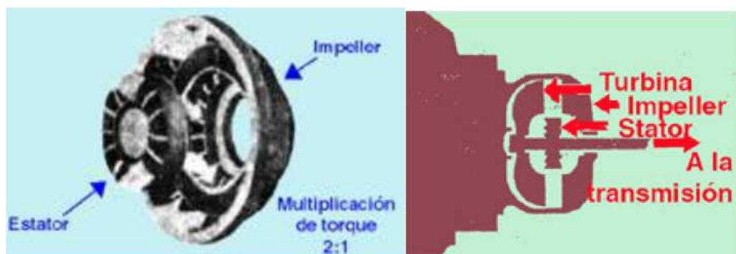
Figura 61. Función del Impeler, Estator y Turbinas.
