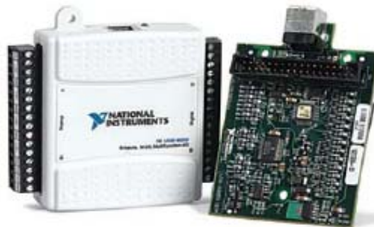
Figura 18. Tarjeta de adquisición de datos DAQ-6009
