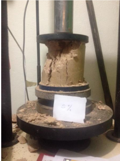
Fotografía 3. Probeta fallada con mezcla de suelo-cemento al 5%
