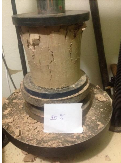
Fotografía 5. Probeta fallada con mezcla de suelo-cemento al 10%
