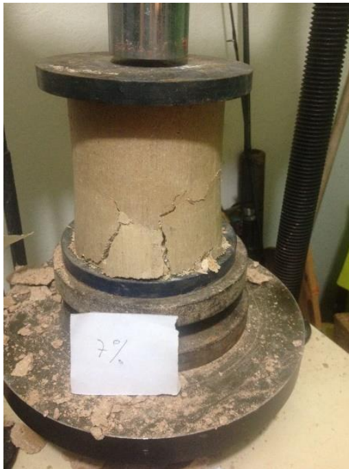
Fotografía 4. Probeta fallada con mezcla de suelo-cemento al 7%
