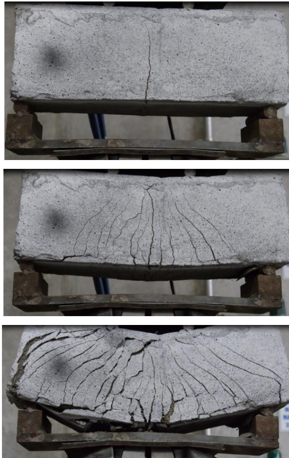
Figura 20. Proceso de Falla Viga Tipo O
