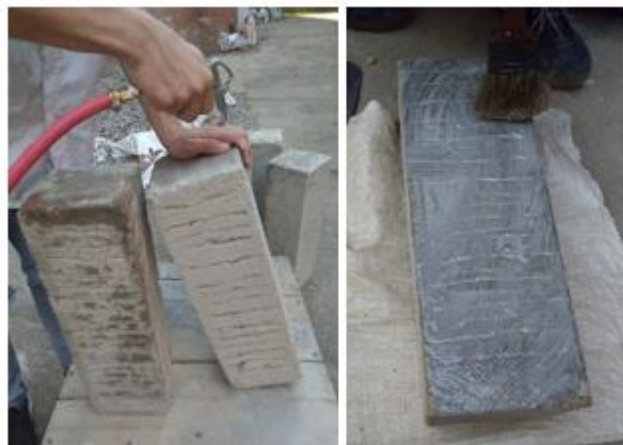
Figura 5. Tratamiento de Adherencia
