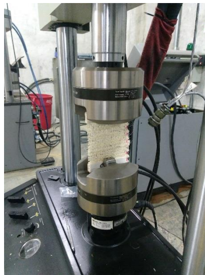
Figura 2. Montaje Ensayo a Tracción en Máquina de Ensayo MTS.
