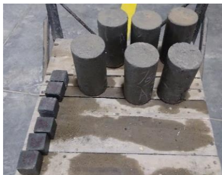
Figura 3. Probetas para control de resistencia (concreto y mortero).
