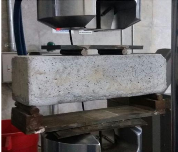
Figura 10. Montaje Ensayo a Flexión
