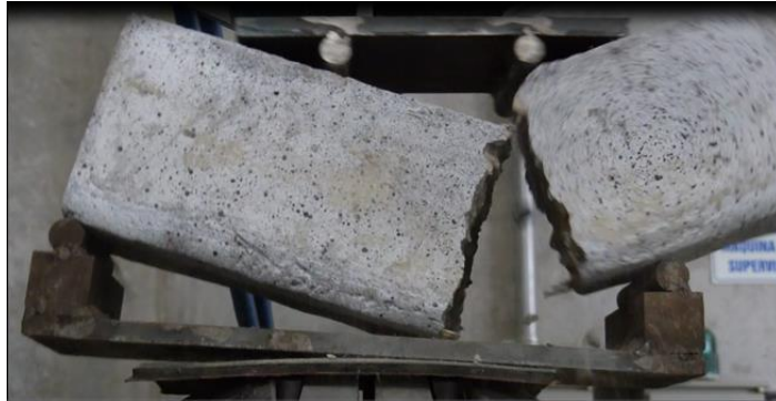
Figura 16. Falla Viga Tipo L.
