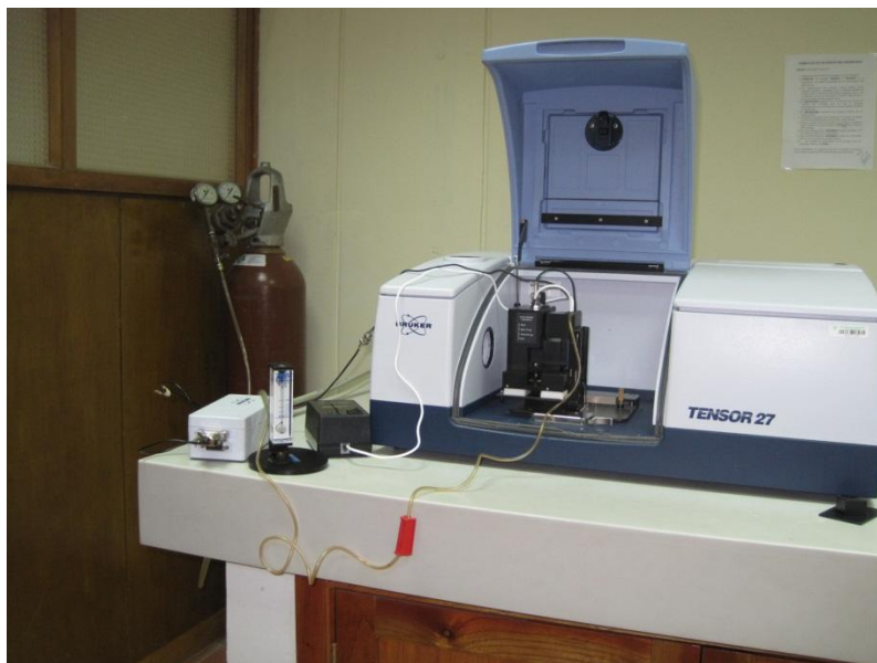
Figura 11. Celda fotoacústica acoplada al equipo de IR
