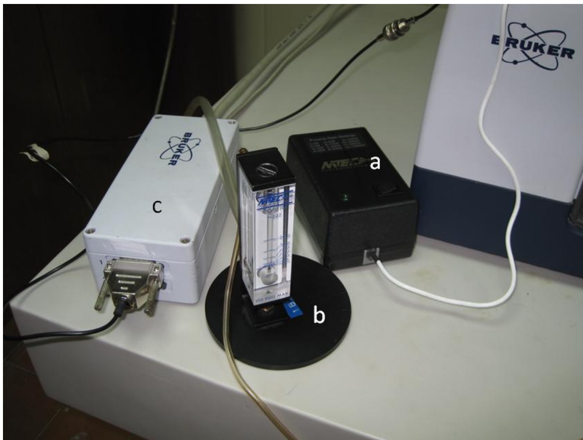
Figura 13. a-amplificador, b-flujómetro, c-interfaz; de la celda fotoacústica
