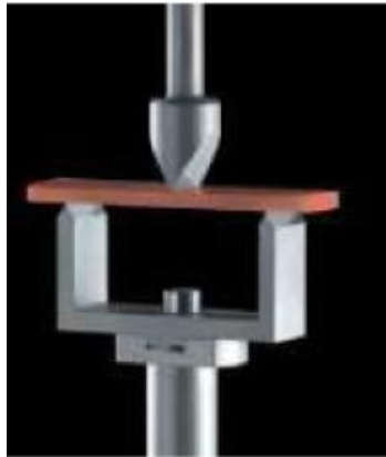
Figura 9. Modo de flexión en tres puntos.
