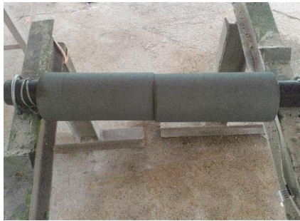
Figura 33. Tubería siendo calentada internamente mediante una resistencia eléctrica
