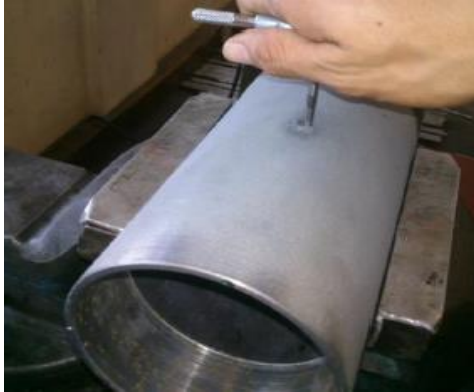
Figura 31. Apertura del agujero en la tubería
