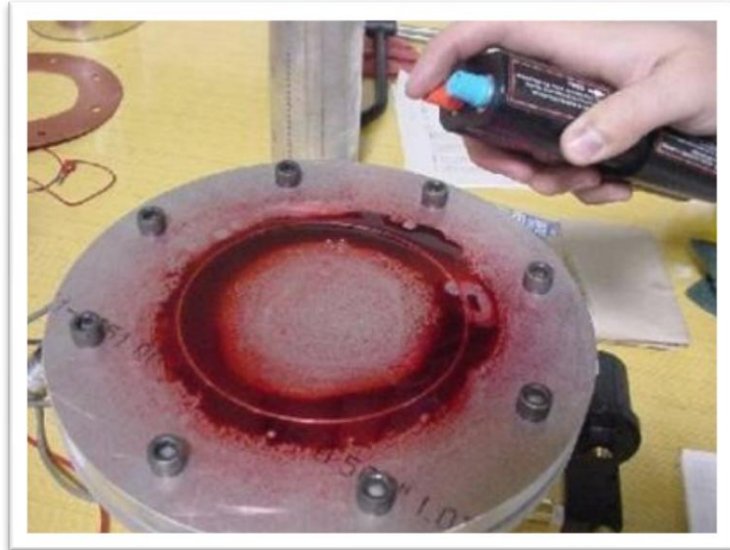
Figura 27. Aplicación del ensayo de tintas penetrantes
