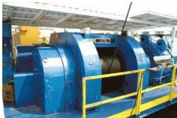
Figura 15. Malacate real usado en la industria petrolera. Adaptado de Manejo de petróleo y gas en superficie. Por Cinzia Zullian.
