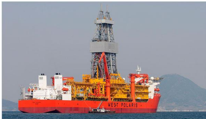
Figura 8. Drill Ship. Adaptado de M&G, Buques para la perforación exploratoria y de producción costa afuera. Por M&G
