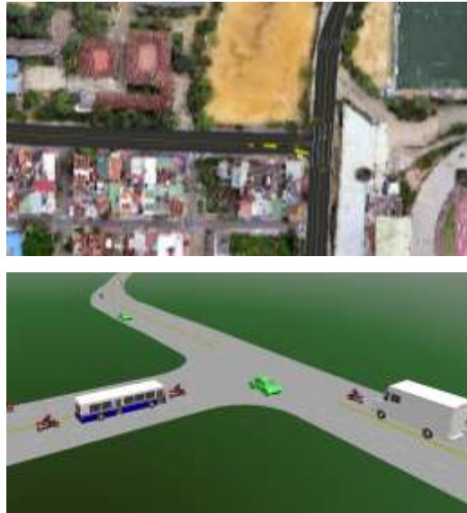
Figura 19. Modelamiento de la intersección de la carrera 30 con calle 10 de Bucaramanga
