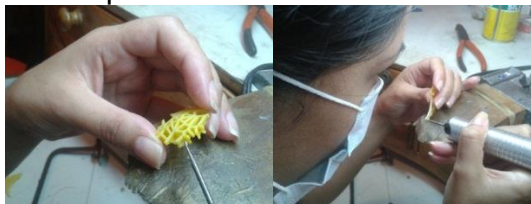
Figura 109. Eliminación de soportes
