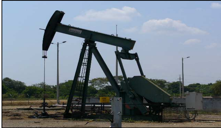
Figura 18. Unidad de bombeo mecánico
