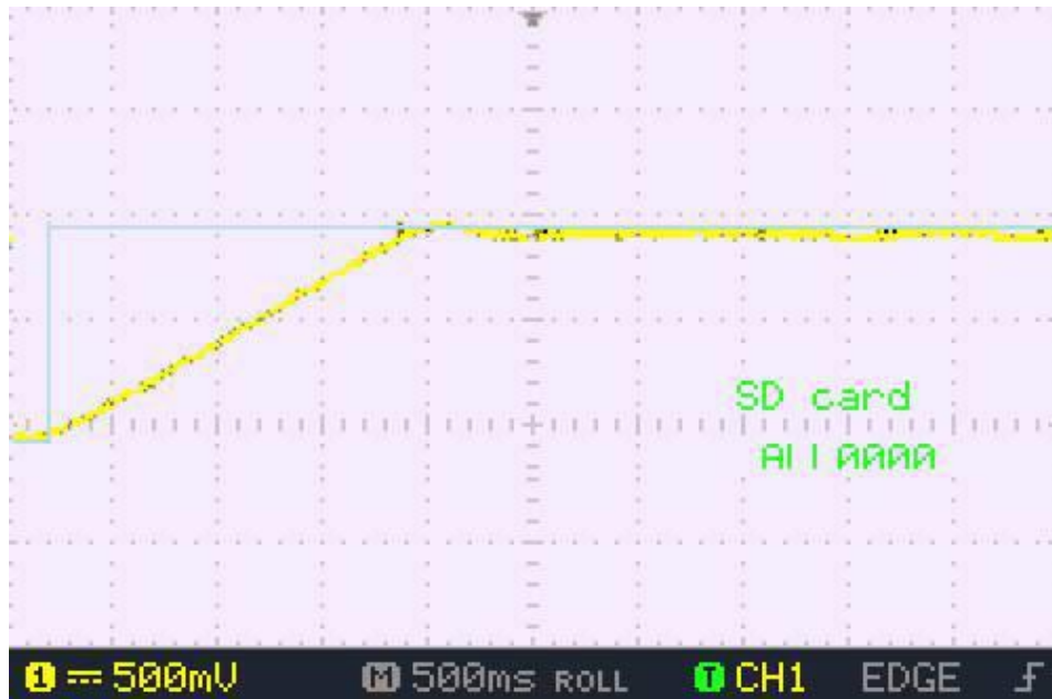
Figura 49. Desempeño del controlador QFT de la cintura ante una entrada escalón
