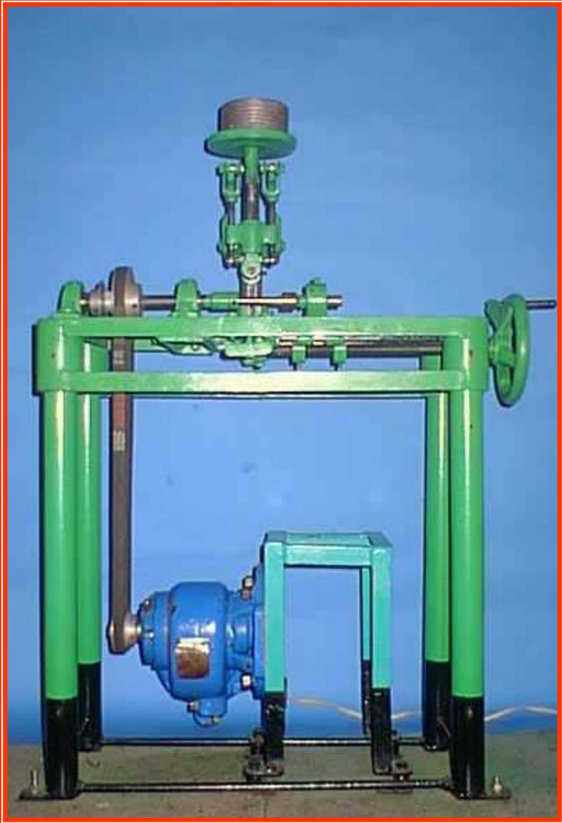
Figura 16. Tribómetro de cilindros cruzados, vistas parciales
