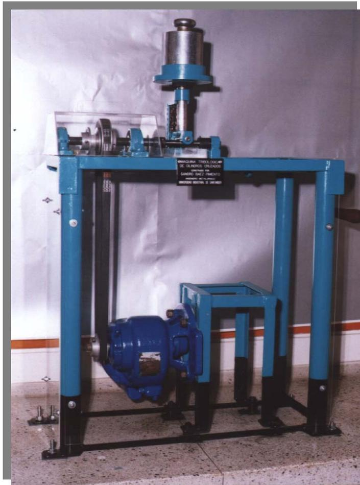
Figura 7. Tribómetro de cilindros cruzados (vista parcial).<sup>12</sup>
