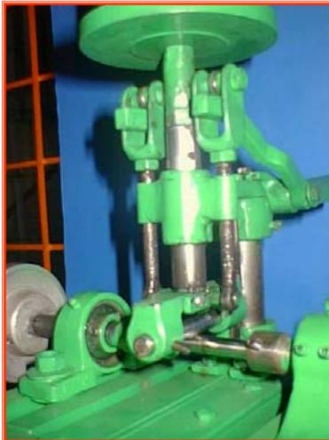
c) Montador de carga y ejes guía
