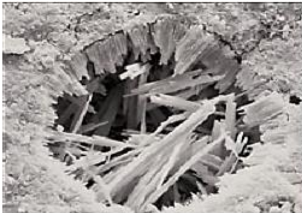
Figura 7. Formación de cristales de etringita en el concreto 38 .
