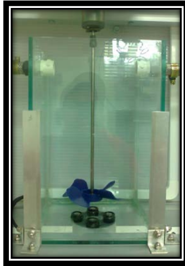
Figura 48. Tanque mezclador (contiene mezcla de agua + tinta))
