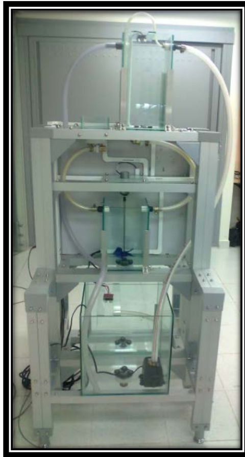
Figura 44. Prototipo estructural ``llenado, mezclado y vaciado de tanques``
