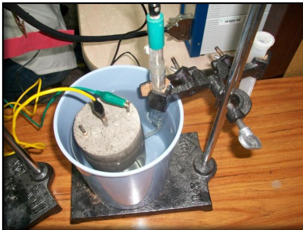
Figura 23. Montaje de la celda electroquímica en el Laboratorio.
