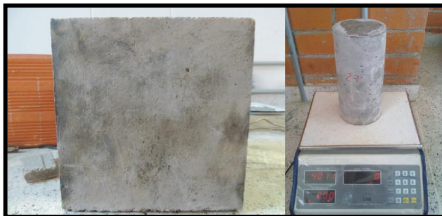
Figura.10. Probetas antes de sometimiento a fuego
