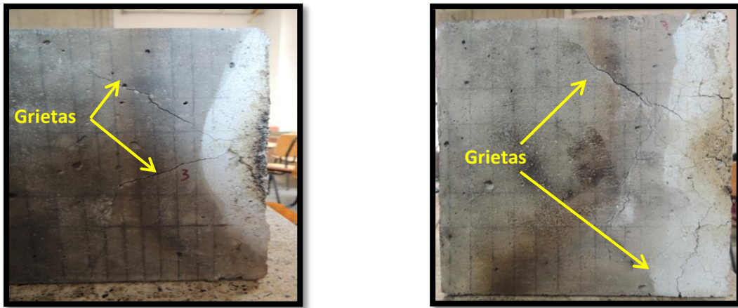
Figura 19. Grietas que se propagan hacia el interior de la probeta sometida a 1000°C
