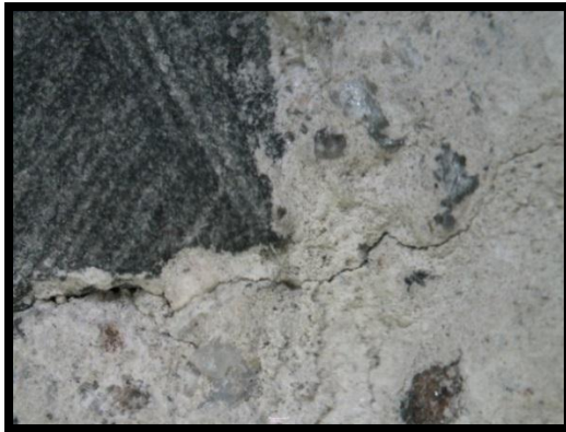
a) Grieta desde agregado a pasta 800°C (17x) b) Grieta desde pasta a agregado 800°C (17x)
