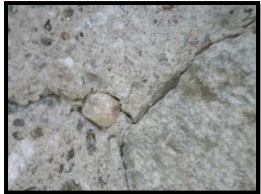
a) Grieta desde agregado a pasta 800°C (17x) b) Grieta desde pasta a agregado 800°C (17x)
