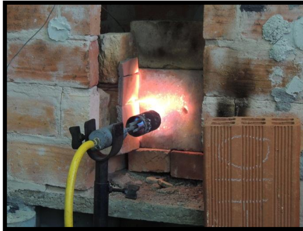
Figura. 9. Horno utilizado en las probetas cúbicas
