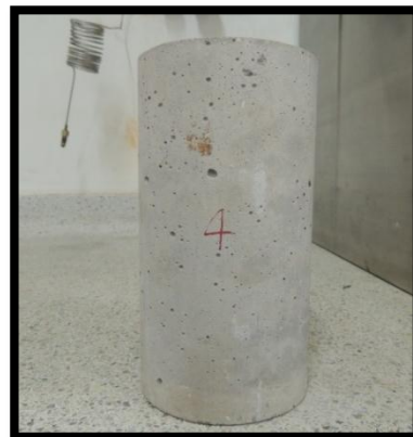
c) Probeta expuesta a 400°C
