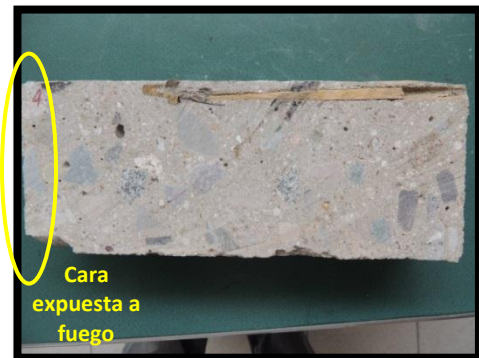
b) Corte probeta expuesta a 400°C
