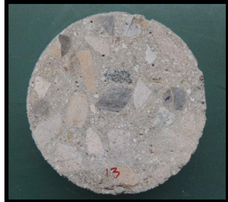
b) Corte probeta expuesta 200°C
