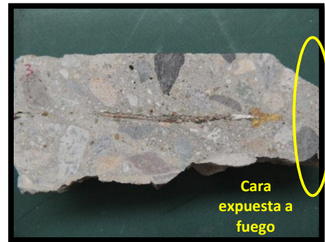
f) Corte probeta expuesta a 1000°C
