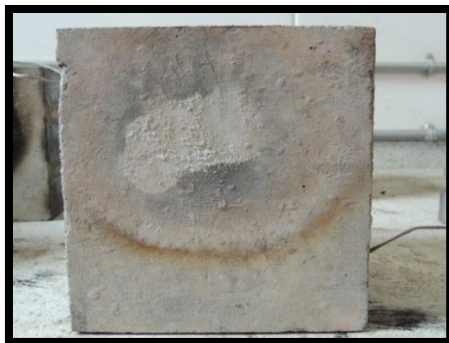
c) Probeta expuesta a 800°C
