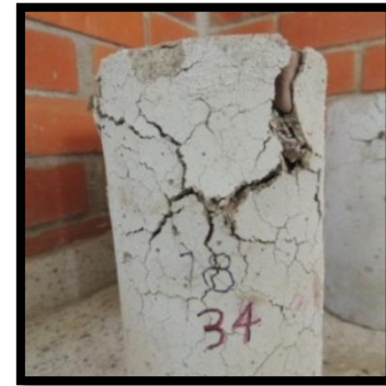
d) Probeta expuesta a 800°C
