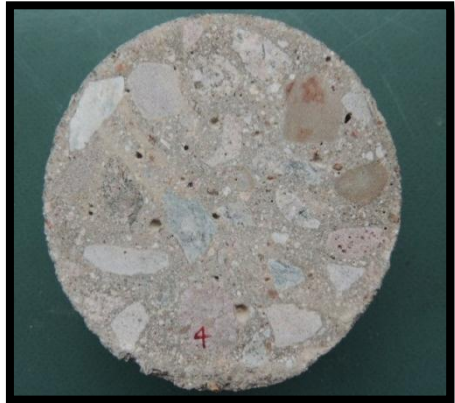
d) Corte probeta expuesta 400°C
