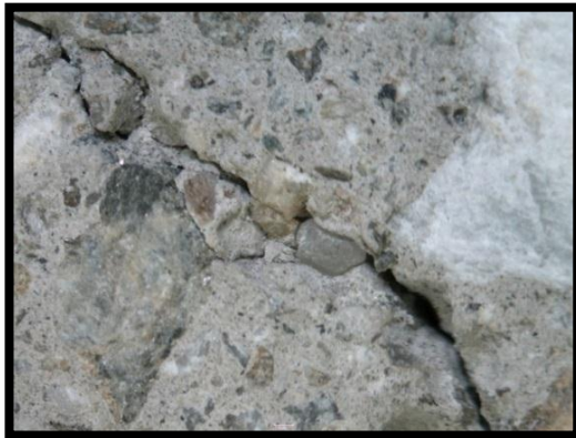
c) Grieta entre agregados y pasta 800°C (17x) d) Corte 400°C a 1 cm de cara expuesta (17x).
