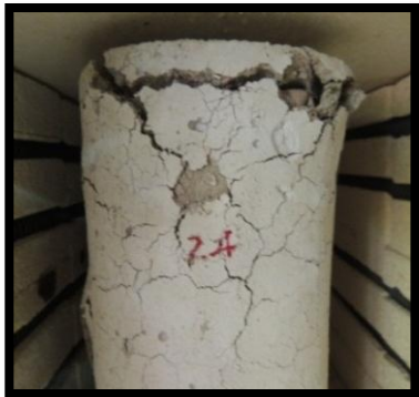
e) Probeta expuesta a 1000°C
