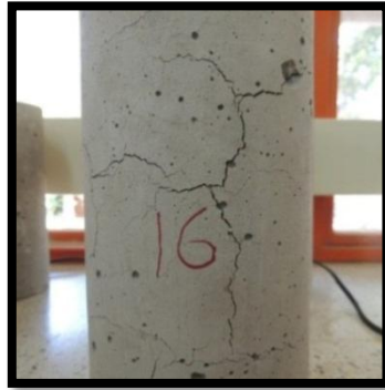
a) Probeta expuesta a 600°C
