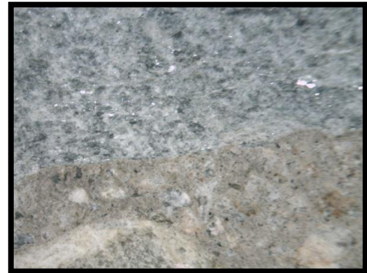
c) Grieta entre agregados y pasta 800°C (17x) d) Corte 400°C a 1 cm de cara expuesta (17x).
