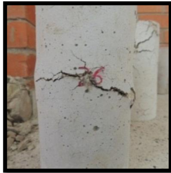
c) Probeta expuesta a 800°C
