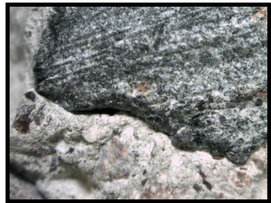
b) Limite agregado-mortero deteriorado (17x)
