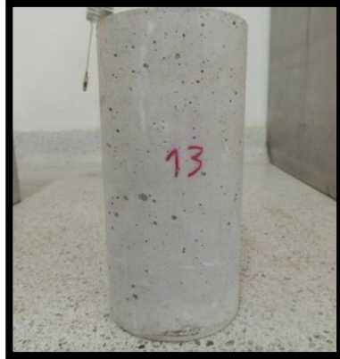
a) Probeta expuesta a 200°C
