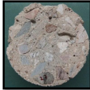
b) Corte probeta expuesta a 600°C
