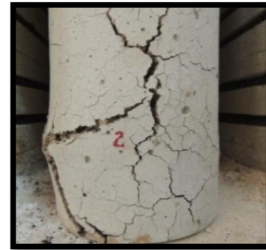
f) Probeta expuesta a 1000°C
