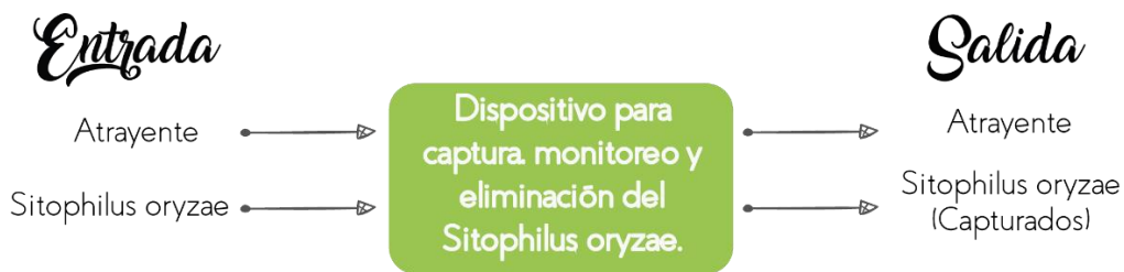
Figura 11. Diagrama funcional básico de una trampa para gorgojos
