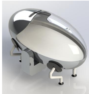
Figura 30. Diseño preliminar cuna con mecanismo de levas.
