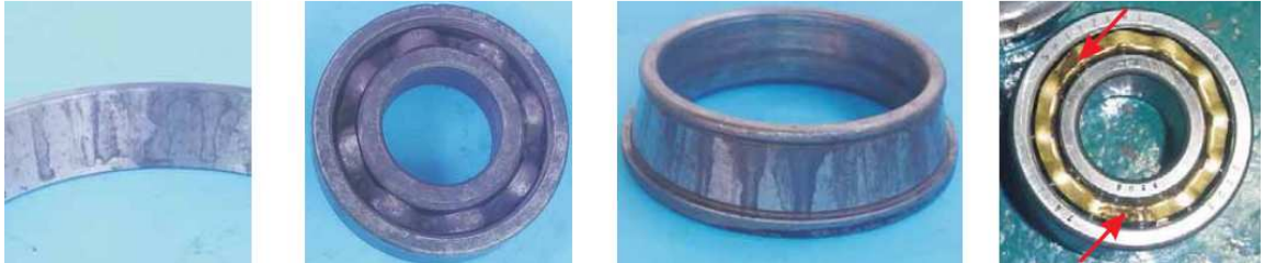
Figura 10. Corrosión en rodamientos
