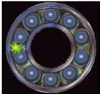
Figura 15. Falla en la canastilla del rodamiento
