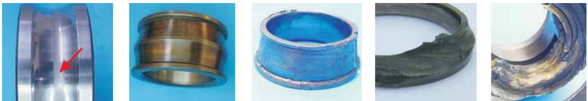
Figura 9. Desgaste adhesivo en rodamientos
