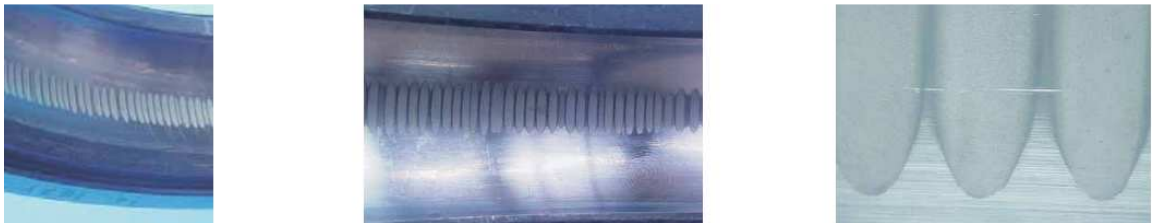
Figura 7. Casos de descarga eléctrica en rodamientos
