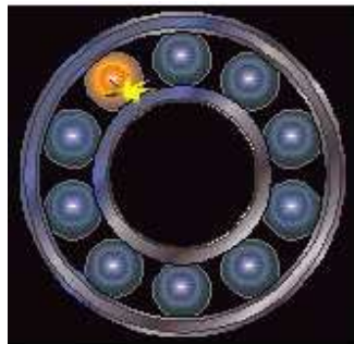
Figura 18. Falla en los elementos rodantes del rodamiento
