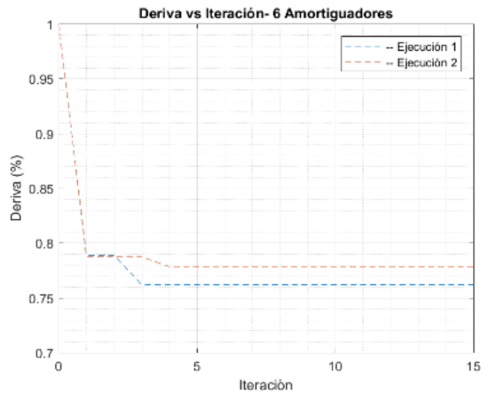
Figura 44. Deriva vs iteración para las 10 ejecuciones con 6 amortiguadores - Ejemplo 2
